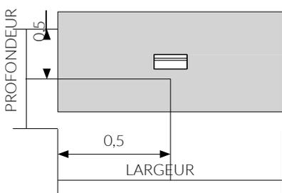
Mediaport situé au milieu de la largeur et de la largeur du plan de travail.
