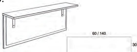
**J. Parement tablette accueil réglable en hauteur. A positionner sur module haut ou retour direct haut.** Position libre, réglable en hauteur (hauteur utile sous tablette de 40,5 à 45cm).
